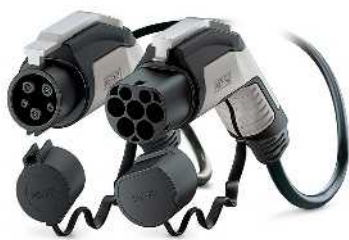
1-es típus (jármű) GB/T-re (nyilvános töltőoszlop), 1-fázisú, szürke-fekete, egyenes metrikus vezetékkel
