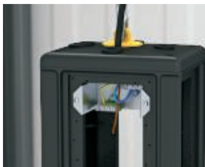
VHF szerelvénybeépítés – védőberendezés Első lépésben a PE-kapocsléccel rendelkező megfelelő tartó ill. N- és PE-kapocsléc kerül előszerelésre a ház felső felében. Ehhez teljesen le kell venni a rögzítőhorony belső részét.
