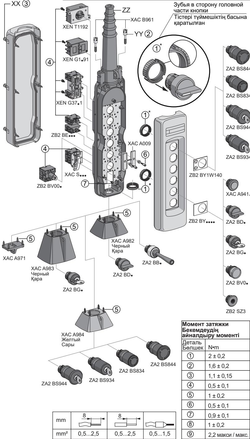
С функцией включения аварийного останова и механическими самоблокирующимися нажимными кнопками
